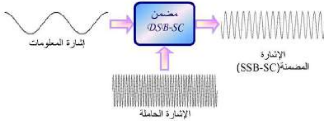
الشكل (6-2) مضمن SSB-SC والأشكال الموجية له
