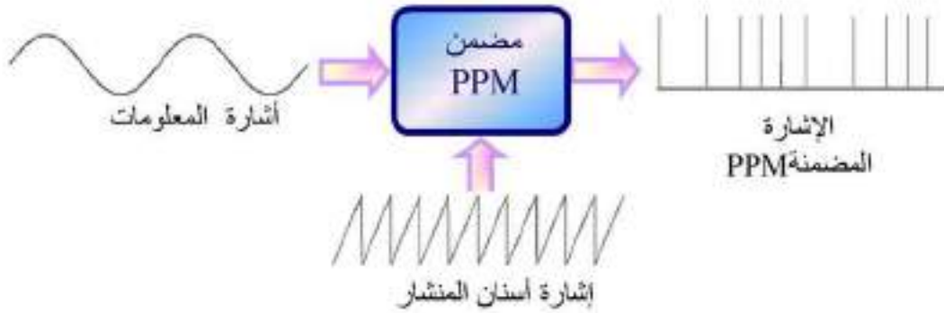
الشكل (11-2) مضمن PPM والأشكال الموجية له
